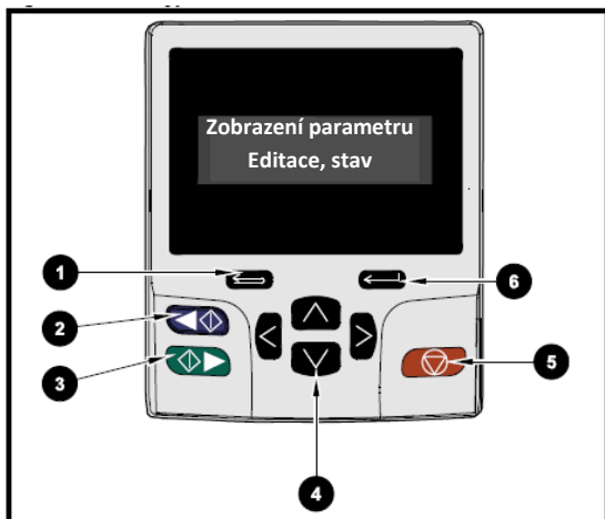
Ovládací panel s klávesnicí a displejem LCD
